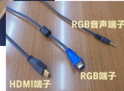
HDMI端子 RGB音声端子 RGB端子
