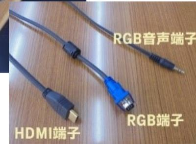
HDMI端子 RGB音声端子 RGB端子
